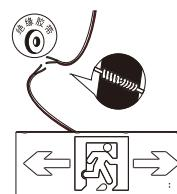
1 按接线图正确接线，并做好绝缘防护处理
