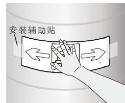
4 将灯具紧贴安装面，并均匀按压灯具表面，然后在灯具两侧贴上安装辅助贴并拉紧
